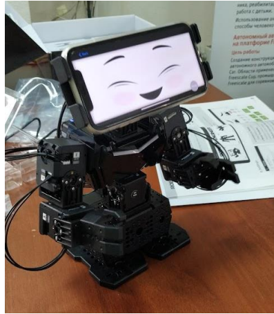
Рис. 1. Мехатронная платформа с установленным смартфоном Разработка движений для социального робота
