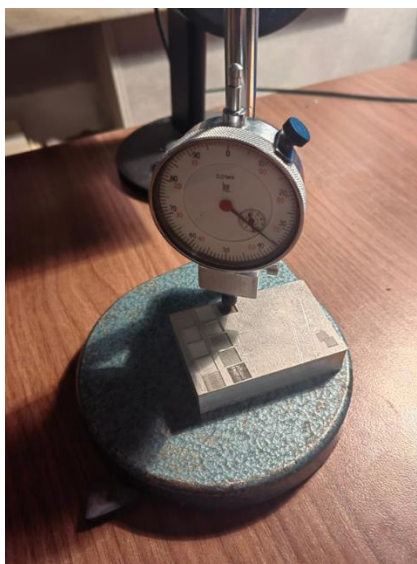
Рис 3. Измерение глубины выработки при глубокой лазерной гравировке
