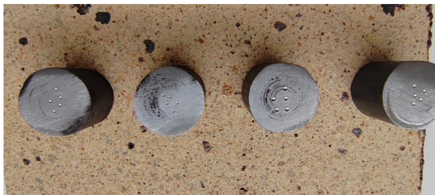
Рисунок 3. Образцы после измерения твёрдости (слева направо: №2 №1 №3 №4)
