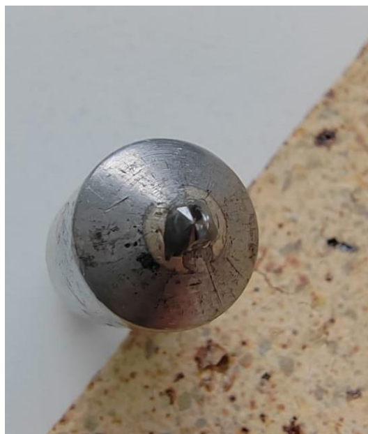
Рисунок 2. Алмазный конус для измерения твёрдости
