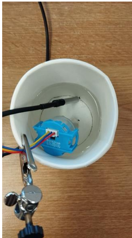
Рисунок 4. Калибровка датчиков (вода с небольшим количеством соли)
