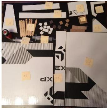
Рисунок 2. Вырезанные шаблоны с указанием необходимого количества деталей для механизма манипулятора
