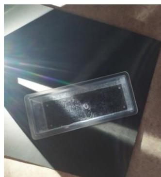
Для третьего опыта я взял оргстекло, в качестве подложки использовал белый лист бумаги и светил лазерной указкой сквозь несколько ёмкостей в разных положениях. Наблюдаем не только преломление, но и частичное отражение луча.
