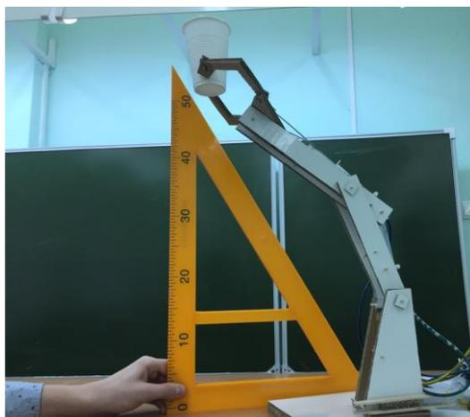
Рисунок 1. Измерение высоты подъема груза.
