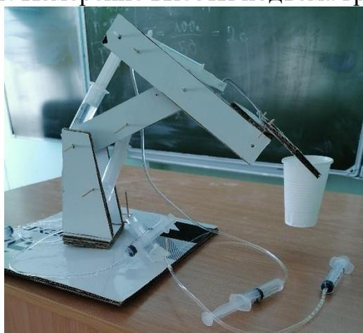
Рисунок 2. Измерение максимального веса тела, поднимаемого грузом манипулятором
