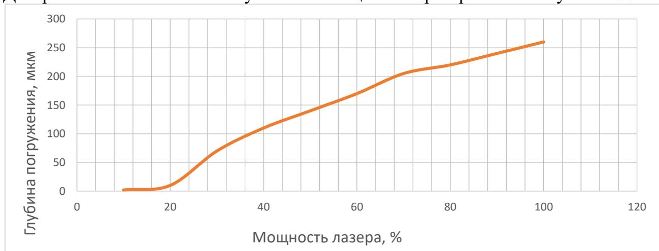
Диаграмма 2. Зависимость глубины от мощности при времени импульса 100нс.
