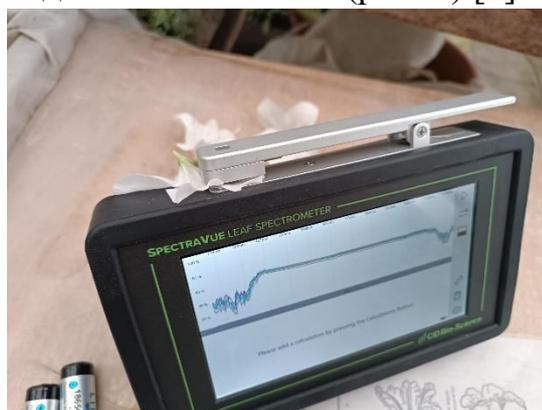
Рисунок 2 - Миниспектрометр CI-710s
