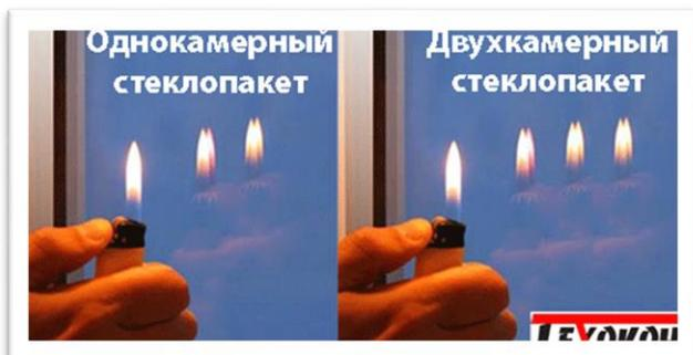
*Оборудование:* стеклопакет, зажигалка или свеча.
