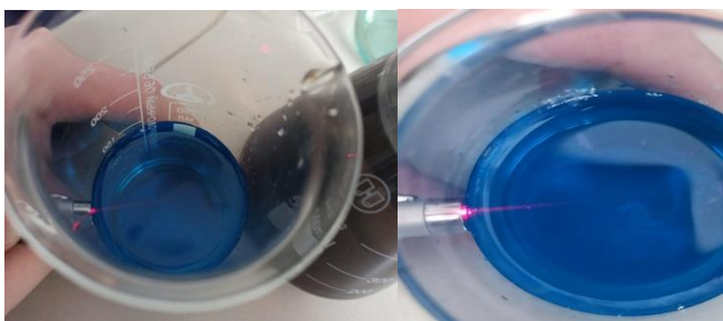
Рис 2. Эффект Тиндаля через раствор полученный «простым способом» (слева) и через раствор, полученный с использованием стабилизатора (лимонная кислота) (справа).
