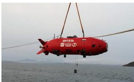
Рис. 2. Подводный робот «Витязь»
