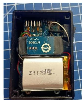
Рисунок 11. Второй этап сборки в корпусе.
