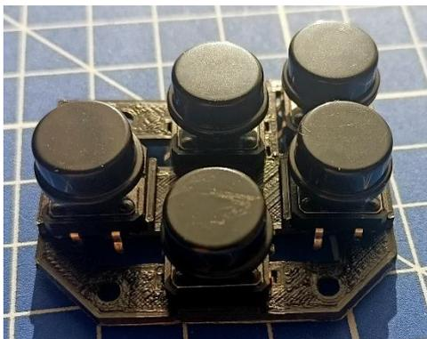
Рисунок 9. Блок кнопок.
