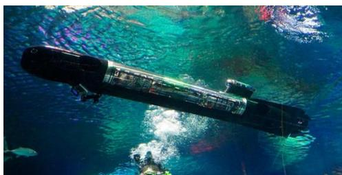
Рис. 1. Подводный робот «Амулет»
