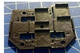
Рисунок 8. Крепление кнопок.
