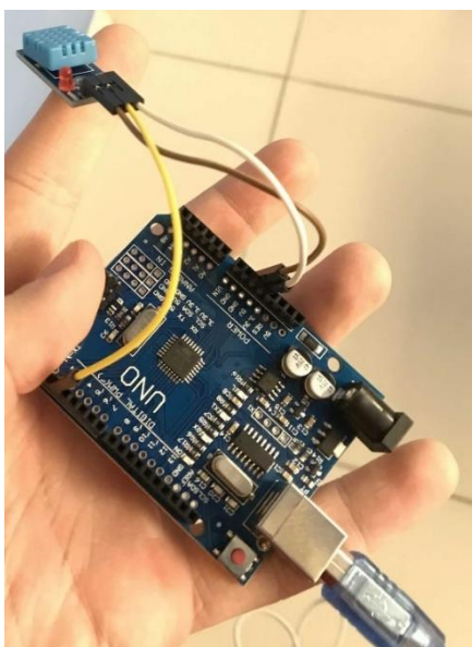
Рисунок 4. Плата arduino с термодатчиком
