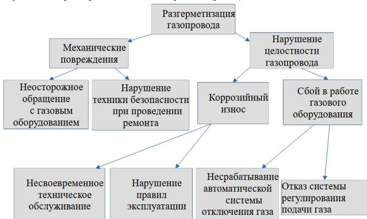
Рис.3 Дерево отказов при аварии на газовом оборудовании в жилом доме
