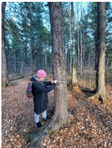
Рис. 2 Измерение диаметра ствола дерева
