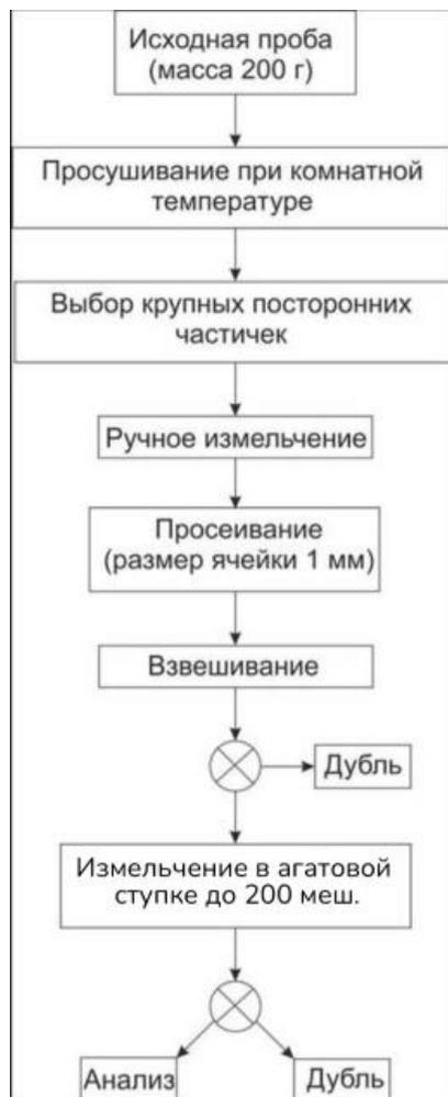
Рисунок 1 – Схема обработки и анализа проб донных отложений
