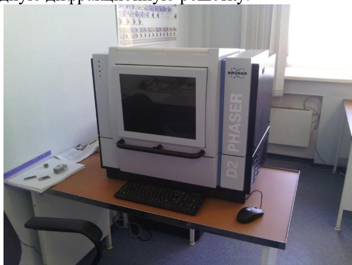
Рисунок 3 – Общий вид дифрактометра BrukerPhaserD2
