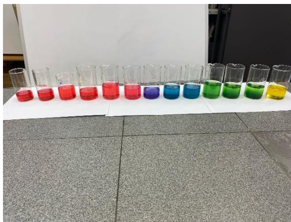
Рисунок 2 – Добавление в растворы разной кислотности индикатора краснокочанной капусты
