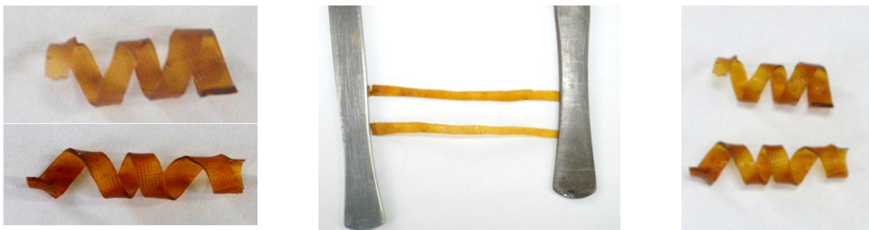
Рис.2. Эффект памяти формы сложной конструкции, сформированной с использованием пленки эпоксидного витримера до и после переформования
