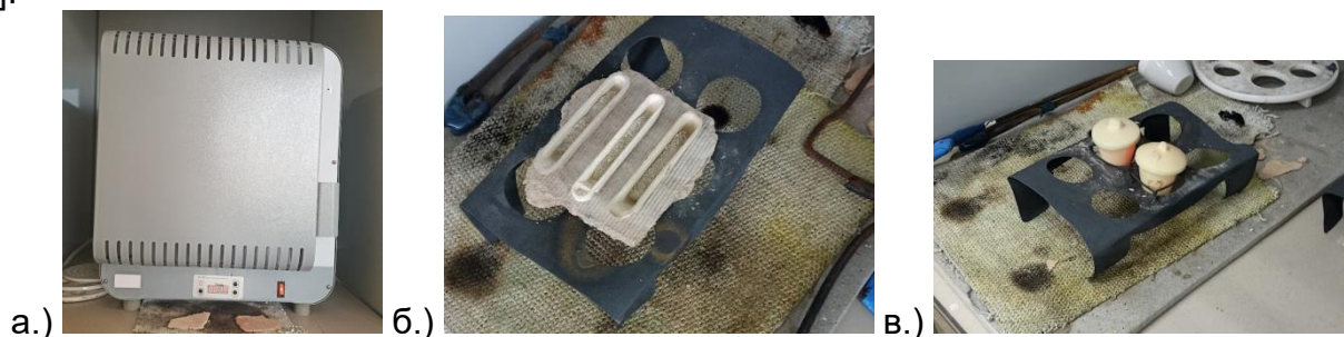
Рис. 5. Результаты экспериментального определения зольного остатка и выхода летучих веществ: а - муфельная печь. б - зола. в - раскалённые тигли со шротом.
