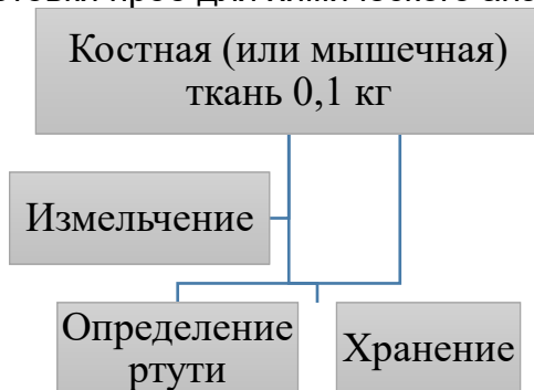
Рис. 1 Схема пробоподготовки рыб для химического анализа
