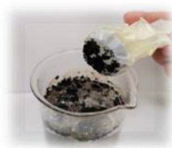
Рис.4. Сбор сорбента с водной поверхности с помощью магнита
