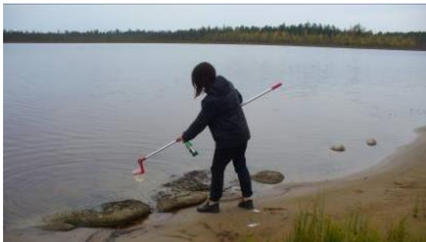
Рис. 1 Забор воды пробоотборником на участке № 6.
