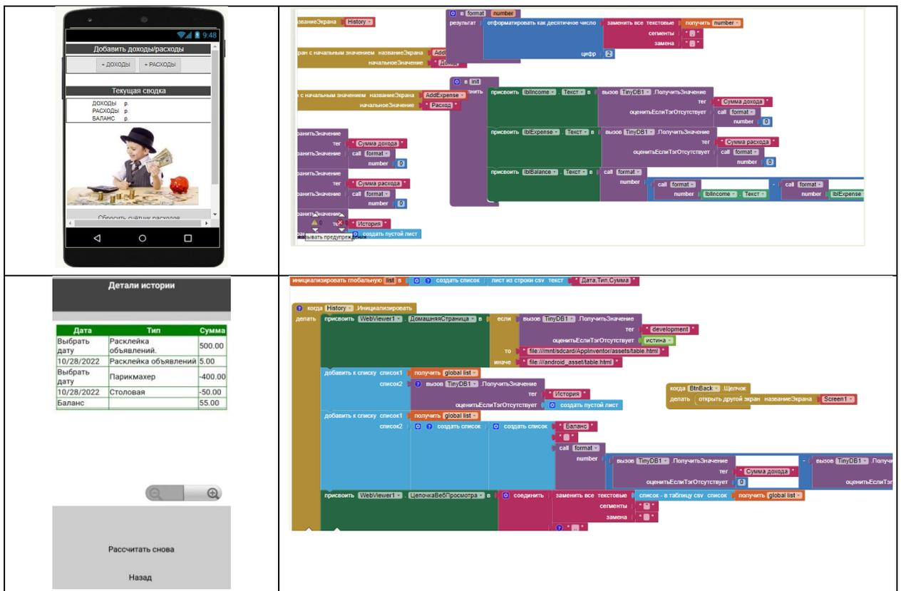
Рисунок 1. Интерфейс мобильного приложения в режиме «Дизайнер» и «Блоки»
