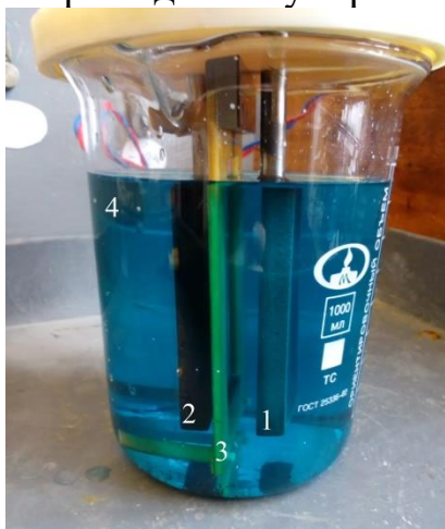
Рисунок 1. Установка для наблюдения дифракции ионов меди. 1 – анод, 2 – катод, 3 – диэлектрический экран, 4 – раствор медного купороса
