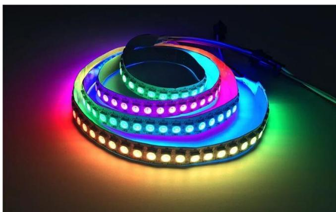
Рис. 6. Адресная светодиодная лента ws2812
