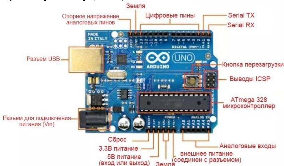
Рис.1. Плата Arduino Uno
