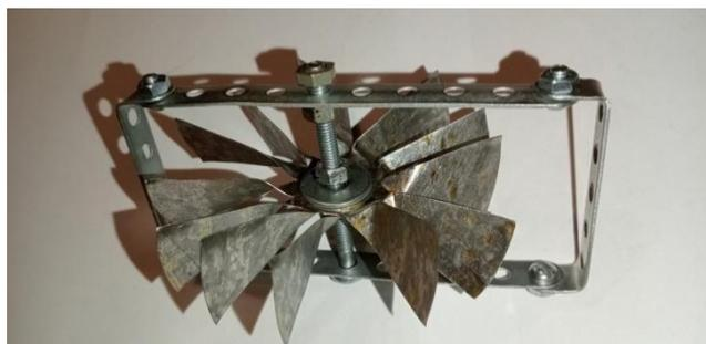
Рисунок 8. Соединение подставки с крыльчаткой
