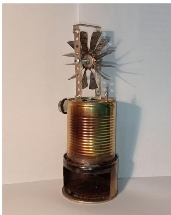
Рисунок 9. Модель паровой турбины
