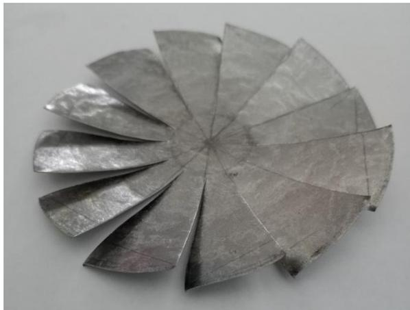
*Рисунок 7. Изготовление лопасти паровой турбины*
