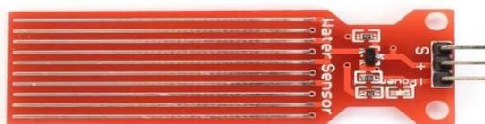
Рис. 2. Датчик протечки воды, влажности
