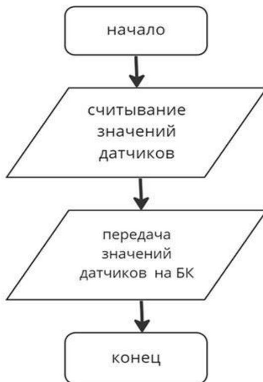
Рисунок 4 - Блок схема работы кода полезной нагрузки
