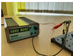
рис. 2 Зарядка конденсатора 2200 мкФ*10 В.
