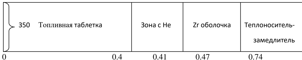
Рис. 1. Геометрия элементарной ячейки ВВЭР-1000
