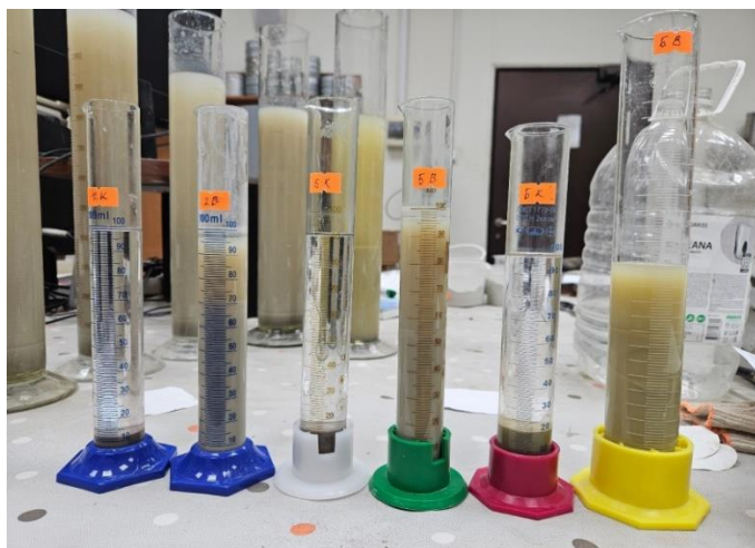
Рис.9.Набухание грунта в керосине и воде по методу IS 2720
