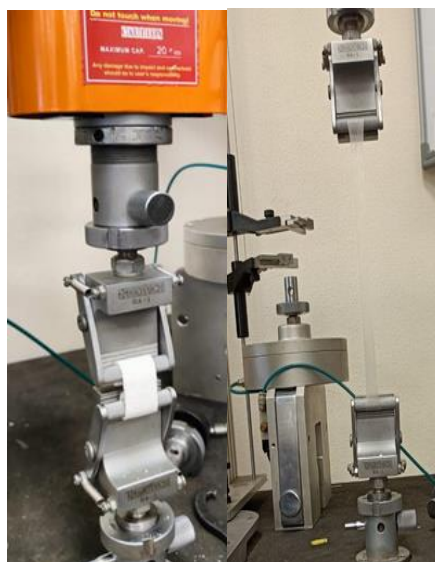
Рис. 1 – Определение прочности на разрыв на универсальной испытательной машине AI-7000-M
