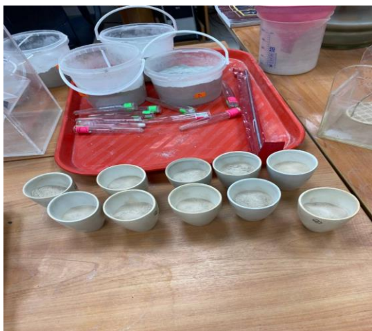
Рис.7. Грунт после прокаливании в муфельной печи
