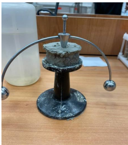
Рис.3. Конус опущенный в грунтовую пасту при определении влажности границы текучести
