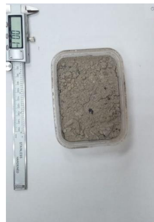
Рис. 4. Образец золы с нанесенным раствором №6 (50% Бентонит (3%-ый р-р в воде) + 50% ПВС (5%-ый р-р в воде))
