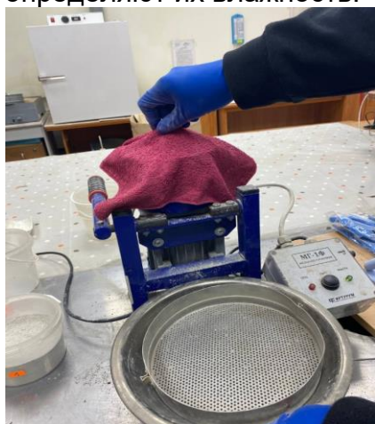
Рис.1. Мельница грунтовая МГ-1Ф и мелкое сито для подготовки грунта
