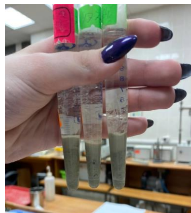
Рис.6. Грунт после отстаивания и набухания
