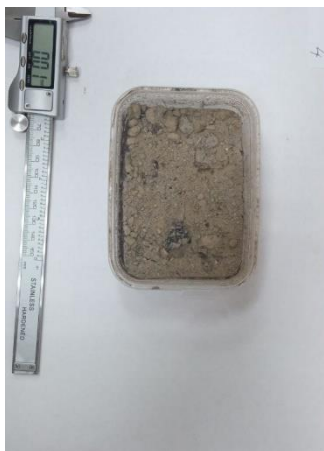
Рис. 2. Образец золы с нанесенным раствором №1 (50% Бентонит (5%-ый р-р в воде) + 50% ПВС (5%-ый р-р в воде))
