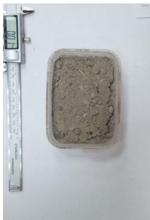
Рис. 3. Образец золы с нанесенным раствором №2 (50% Бентонит (4%-ый р-р в воде) + 50% ПВС (5%-ый р-р в воде))
