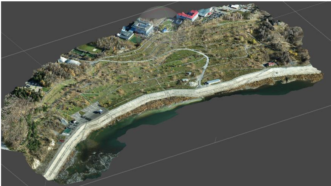
Рис.3. Фото цифровой модели оползневого склона Лагерного сада в ПК Agisoft Metashape
