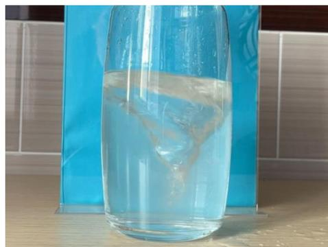
Опыт №2. Затем я взяла вращательный элемент миксера с небольшой лопастью на конце и поместила его в стеклянную банку, заполненную водой на три четверти.
