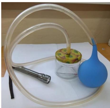
Рис. 3. Камера Вильсона из банки.
