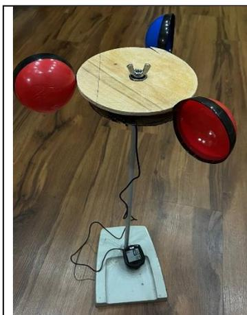
Собираем конструкцию: устанавливаем картонную часть на штатив с помощью изолянта и металлических деталей; деревянную часть устанавливаем выше, закрепляем с помощью крепежа.
