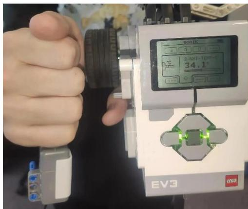
Рис. 5. Определение показаний температуры при помощи модуля.
