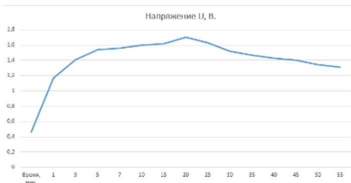
Рисунок № 8. График изменения напряжения от времени при температуре 27°C.
