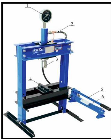
Рисунок 2 – Ручной гидравлический пресс: 1 – манометр, 2 – трубка подачи масла, 3 – шток гидравлического пресса, 4 – основание, 5 – манипулятор, 6 – масляный насос гидравлического пресса
