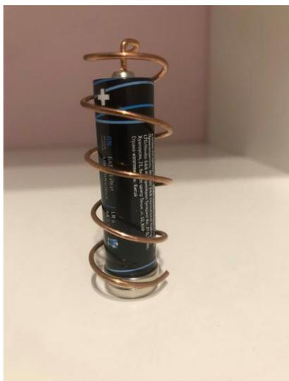
Рисунок 2 Модель номер 1 униполярного двигателя со спиральной формой контура
