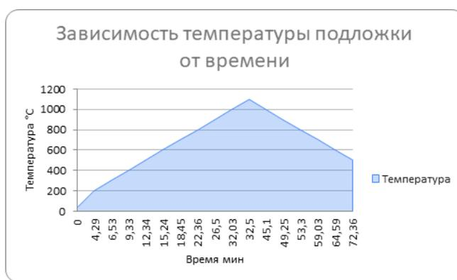
Рис. 1. График зависимости температуры подложки от времени нагрева атмосферной печью
