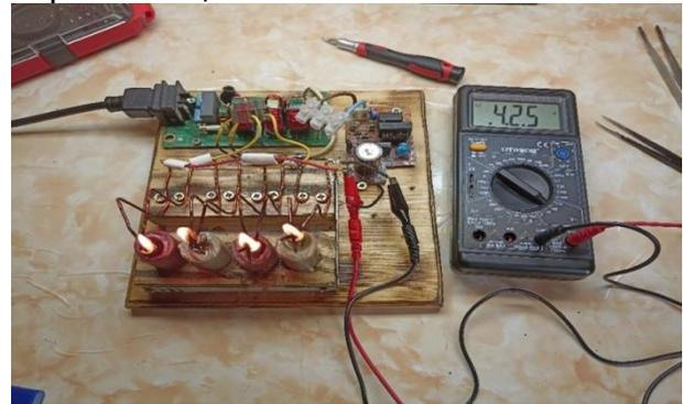
Рис. 5. Измерение переменной составляющей напряжения с выпрямительного моста из свечей
