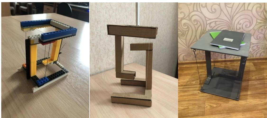
Рис. 12. Тенсегрити конструкции из лего, картона и фанеры
