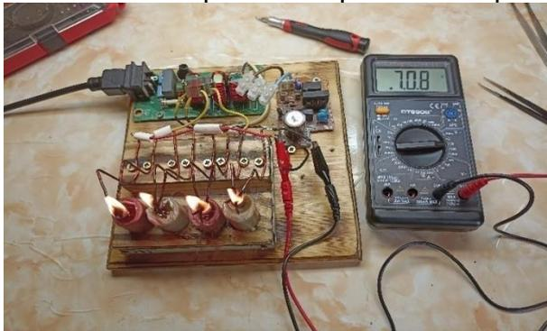
Рис. 4. Измерение постоянной составляющей напряжения с выпрямительного моста из свечей
