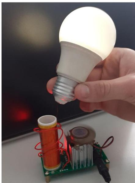
Рис.2. Демонстрация разряда в энергосберегающей лампе
