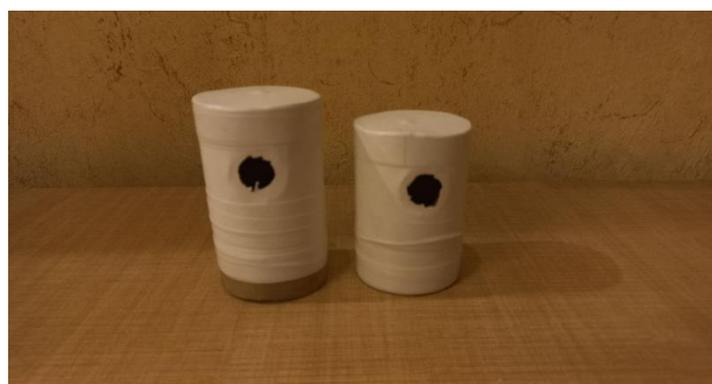
Рисунок 5. Разделение резистора на 2 части.
