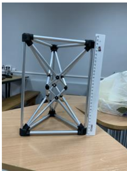
Рисунок 3. Созданный прототип ферменной конструкции
