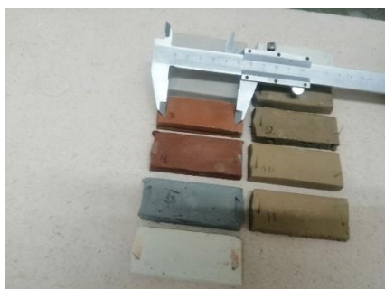
Рисунок 2. Измерение образцов на усадку (слева), гипсовая форма и 3Д-матрица для отливки формы (справа).
