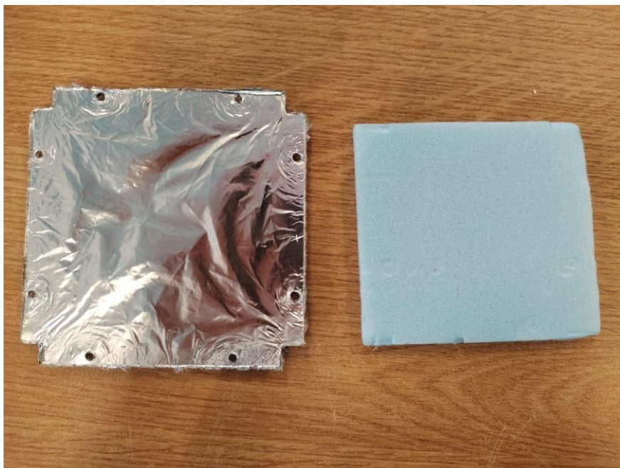
Рисунок 1 - Экранно-вакуумная изоляция (слева), пеноплекс (справа)
