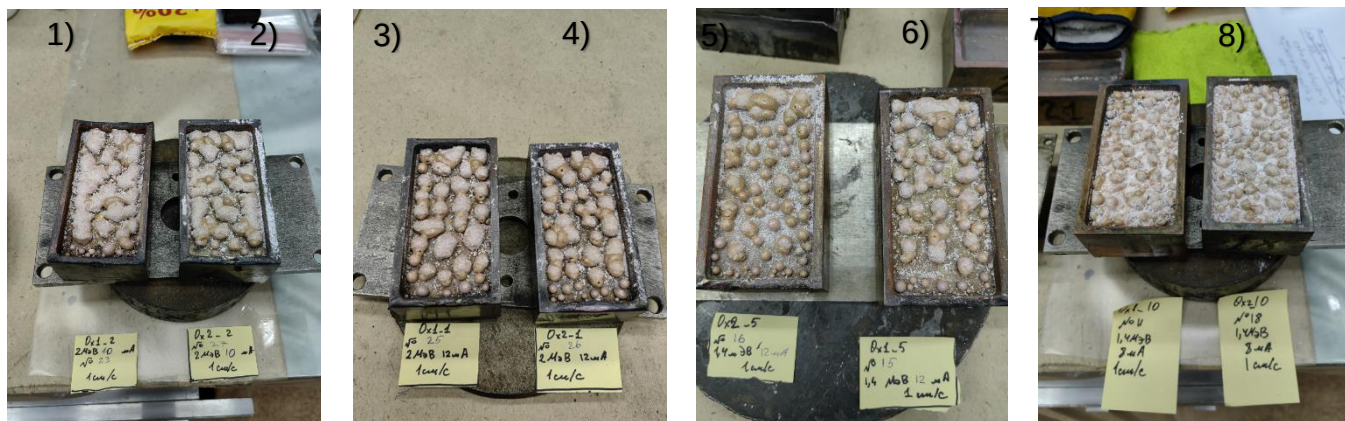
Рис. 4. Фотографии кювет с синтезированными на них образцами ВЭК, при разной механической обработке, разным напряжении и силе тока
