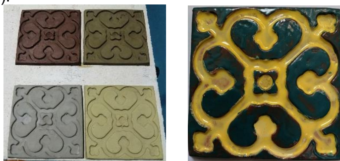
Рисунок 3. Образцы плитки до обжига (слева), обожжённая, покрытая глазурью плитка (справа).
