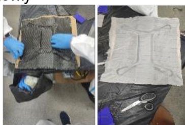
Рис. 3 Процесс укладки углеволокна в оснастку пакета
