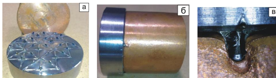
Рис. 4. Вид пирамидальной игольчатой структуры (а); неразъёмное соединение «титан – медь» (б); фрагмент микроструктуры в зоне контакта титановой иглы с медной подложкой (в).
