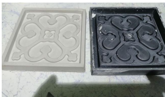
Рисунок 2. Измерение образцов на усадку (слева), гипсовая форма и 3Д-матрица для отливки формы (справа).
