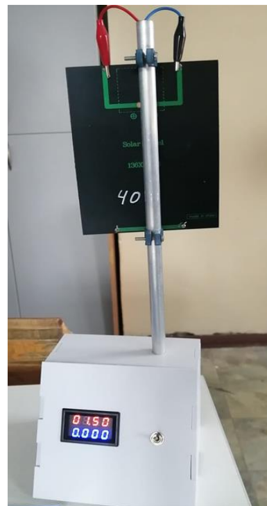
Рисунок 1. Установка для исследования работы солнечных панелей
