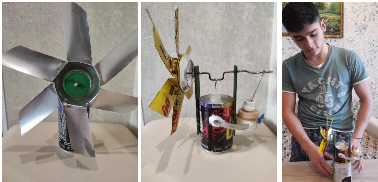
Рисунок № 14,15,16. Сборка всех деталей в единый механизм. Готовая модель двигателя Стирлинга
