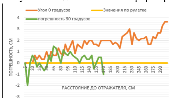
Рис.1. Зависимость погрешности вследствие изменения угла между локатором и отражателем
