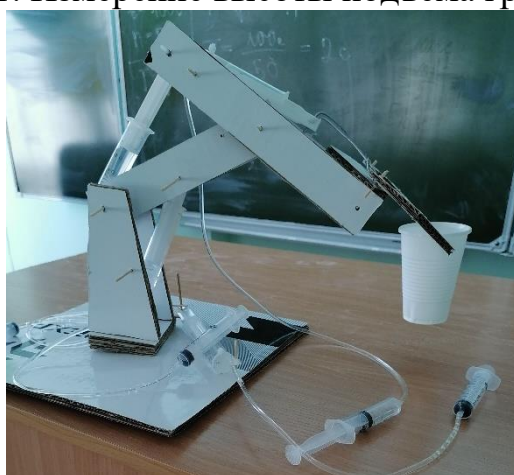
Рисунок 2. Измерение максимального веса тела, поднимаемого грузом манипулятором
