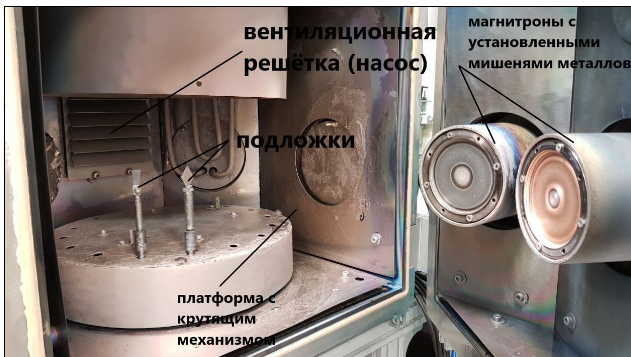
Приложение 3: фотография камеры для проведения реактивного магнетронного распыления
